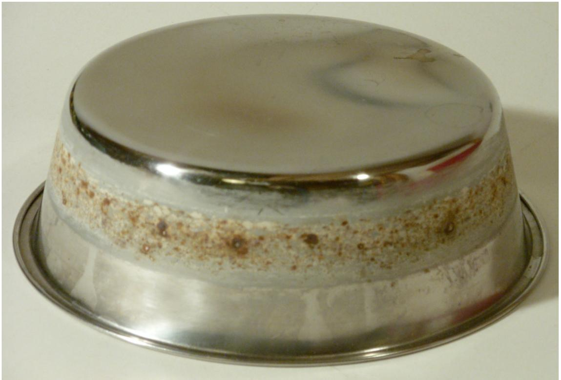
Edelstahl-Futternapf mit unprofilierem, ebenem Boden als Ölwanne; ohne Schutzanstrich rostet die Ölwanne im Wasserbad im Laufe der Zeit durch.
