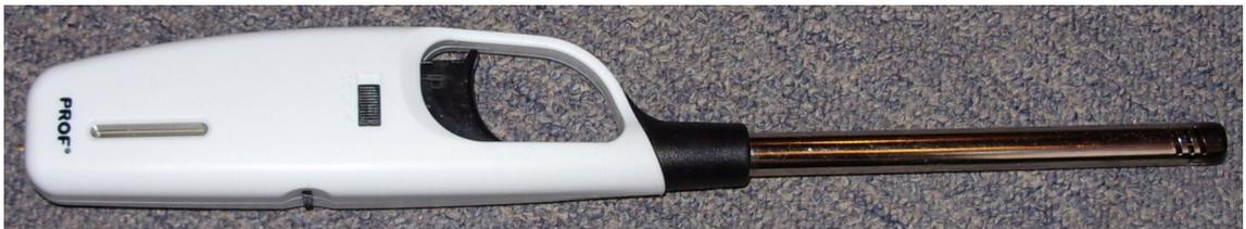
Handelsübliches, nachfüllbares Gasstabfeuerzeug, made in China, wird zu einem EURO angeboten. Auf Vorrat kaufen lohnt sich. Piezozünder verschleißt zuweilen früh, manchmal wird die Flamme mit der Zeit kleiner. Zum Wegwerfen zu schade, solange Gastank und Ventil noch funktionieren, kann bei Piezodefekt mit regulärem Feuerzeug gezündet werden. Gasaustrittsöffnung kann bei Bedarf mit Hilfe einer Nadel gereinigt werden.
