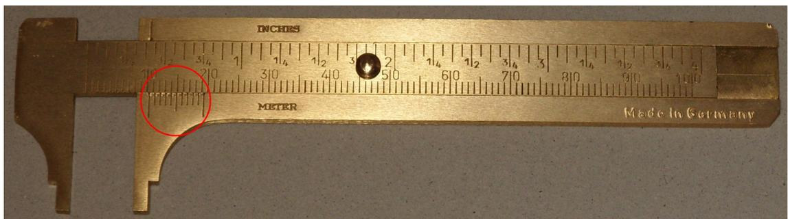
Meßschieber (Schieblehre) mit Ablesehilfe "Nonius" (roter Kreis) für Meßgenauigkeit von zehntel Millimetern.
