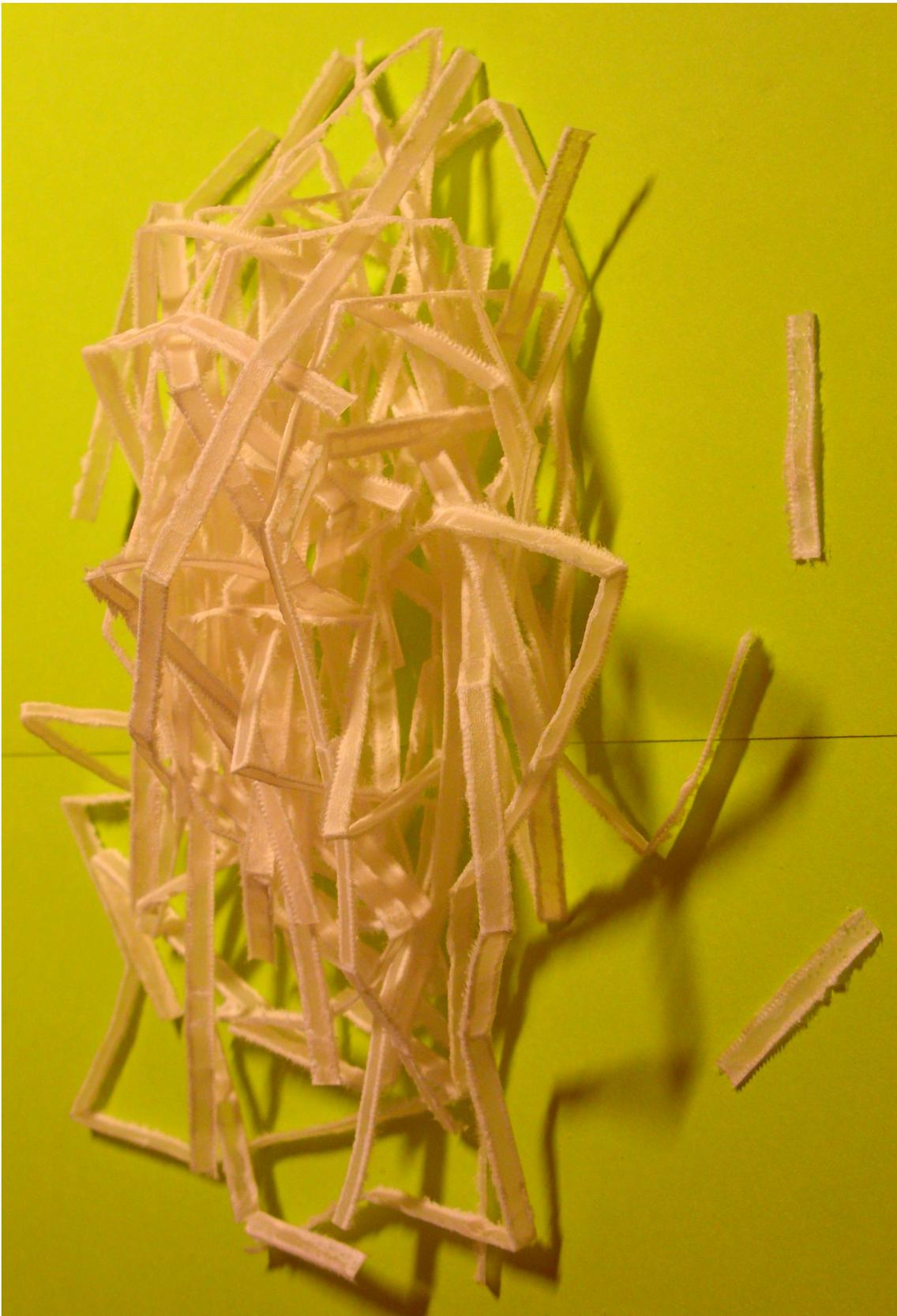
Kälter bedeutet spröder. Legt man das gewachste Papiertaschentuch wenige Minuten in den Kühlschrank, gelingt der Schnitt sauberer, als ungekühlt. Die Schnittkanten sind klarer begrenzt, die Streifen fallen auseinander.
