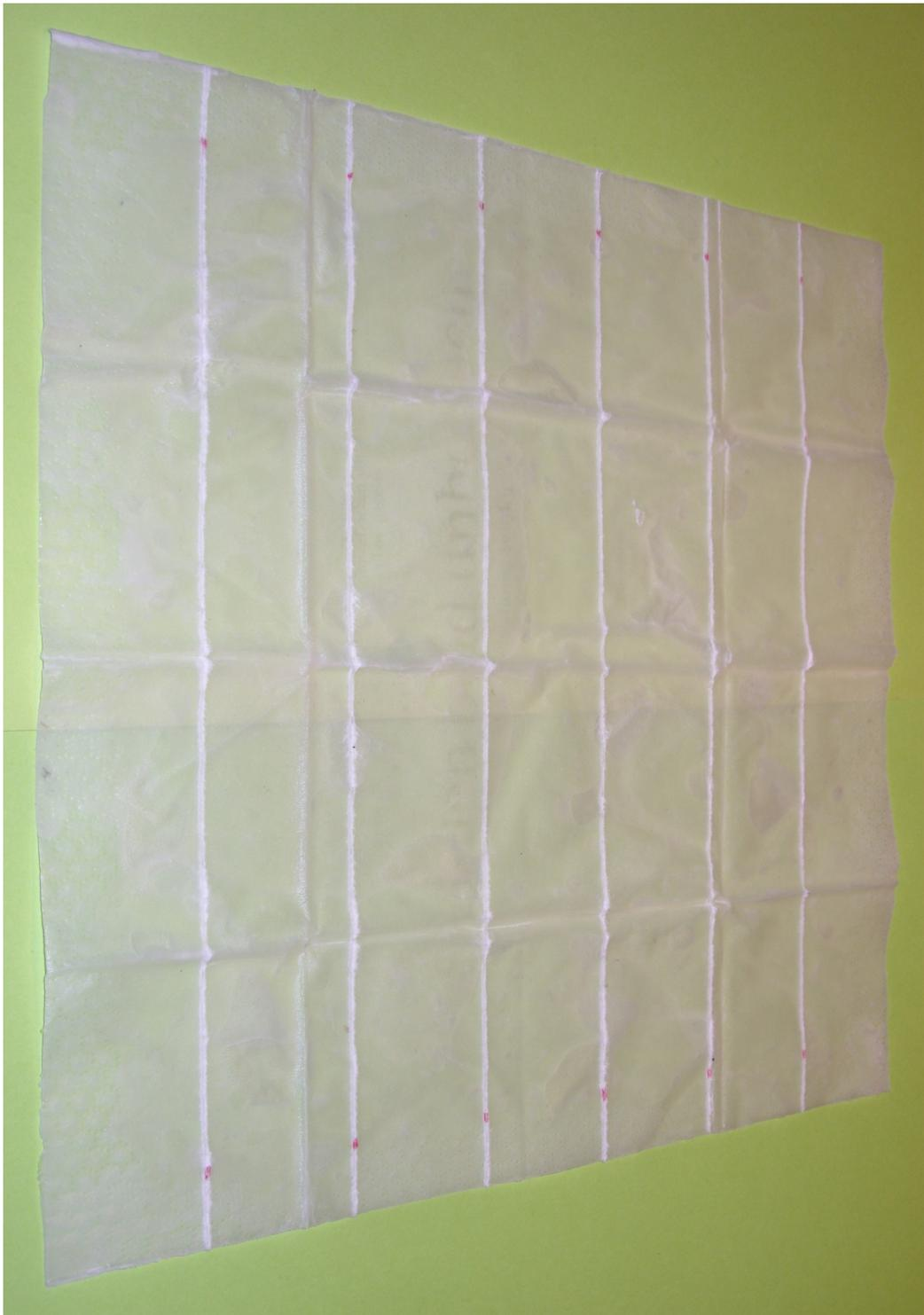
Papiertaschentuch, gewachst, 210 mm Längsseite geteilt durch sieben, mit Cutter angeritzt zu sieben Streifen à 30 mm Breite
